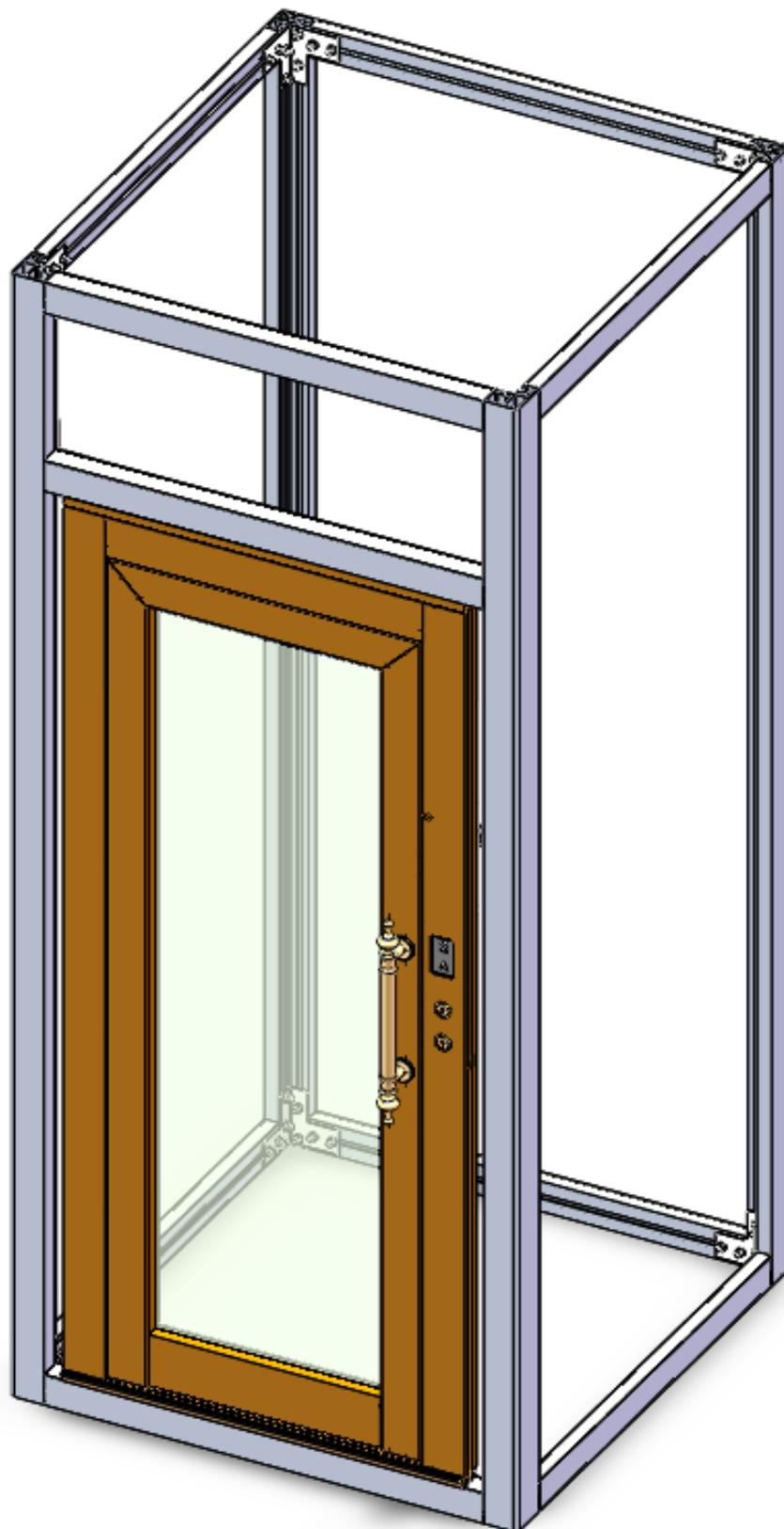
2、把底部连接件用 T 型螺栓与门口横档安装固定。（安装间距随开门距而定）
