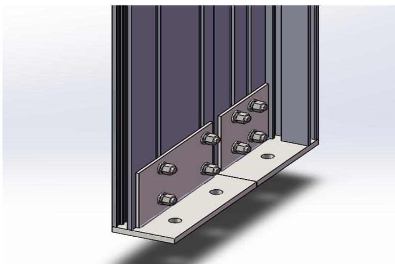
将螺母条提前塞入框架立柱中，后用 M10 平圆头螺栓将立柱连接板固定。保证每根立柱上有至少 3 块立柱连接板。
