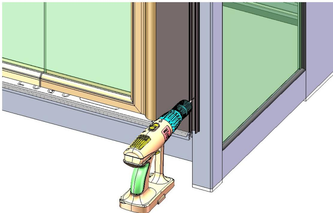
钻孔完成后，在平开门边框与框架间垫入 10mm 钢板（公司有配，8 块/扇），用手枪钻攻入自攻螺钉。
